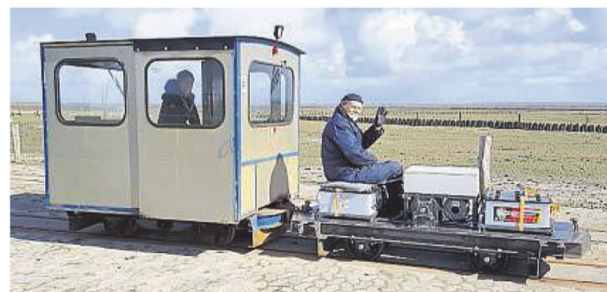
Die Lore von Gerd-Walter Siefert hat Reck von Diesel auf Strom umgerüstet.
