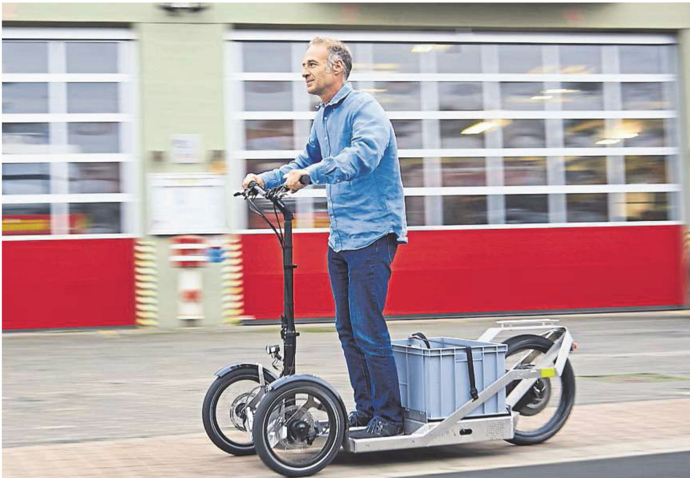
Der SurbX darf 145 Kilo laden und fährt bis zu 20 Stundenkilometer. Foto: Stefan Wildhirt
